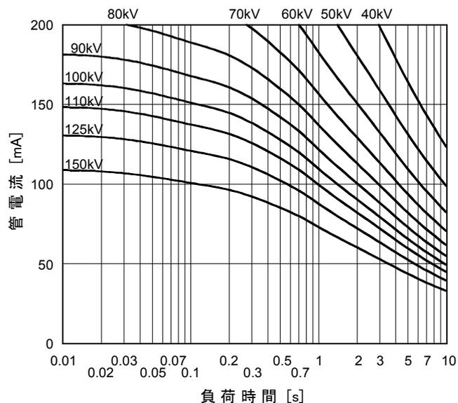
動作条件： 定電圧形 X線高電圧装置
